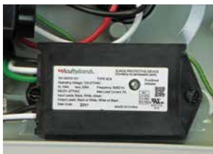
Protección contra sobretensiones de 20 kV/10 kA líder en la industria
